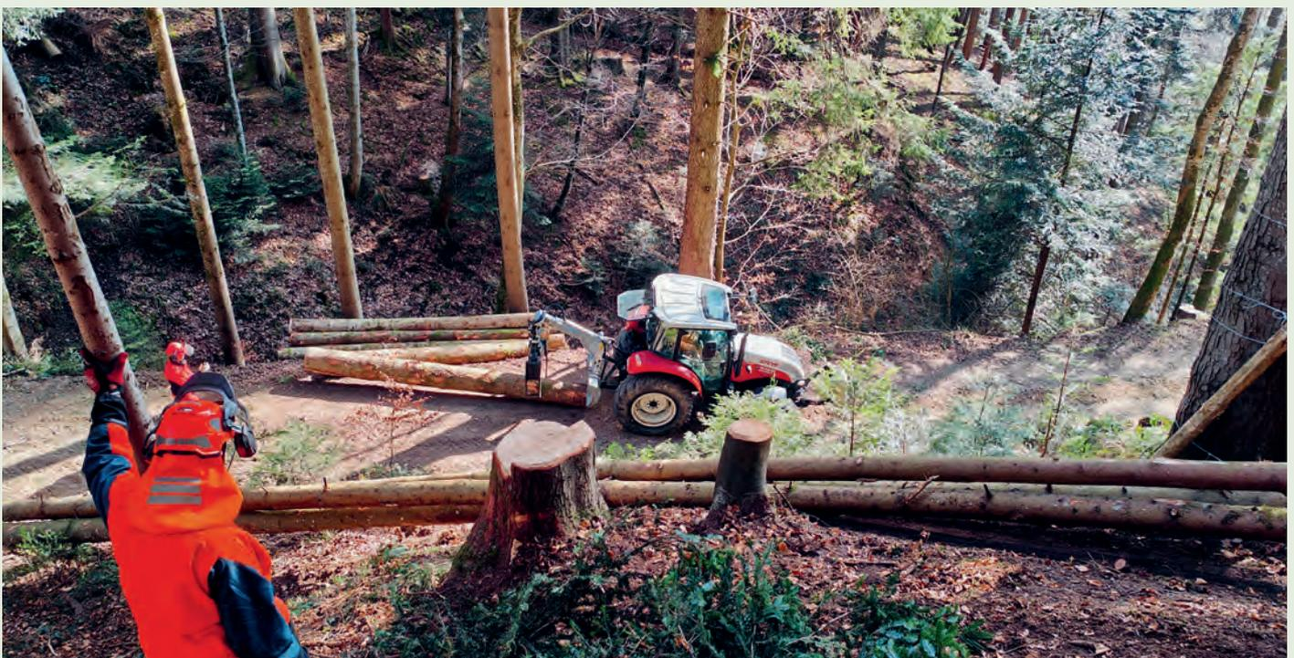
Zum Schutz des verbleibenden Bestandes werden Stöcke zum Umlenken des Holzes genutzt und Stämme mit Holzstücken geschützt.
