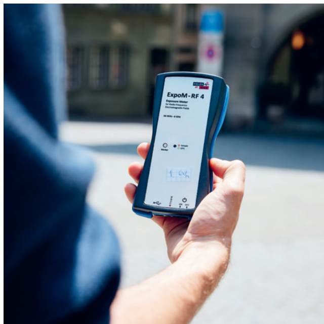
Les appareils sont sortis uniquement pour contrôler qu'ils fonctionnent bien. Ensuite, ils restent dans le sac à dos où ils enregistrent en permanence le rayonnement.
